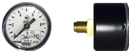
Рис. 10. Манометр (индикатор давления)
