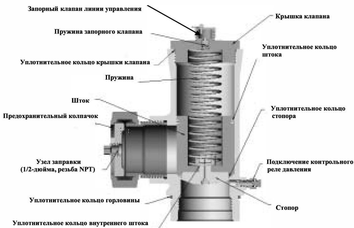
Рис. 4. Запорно-пусковое устройство марки «Kidde»
