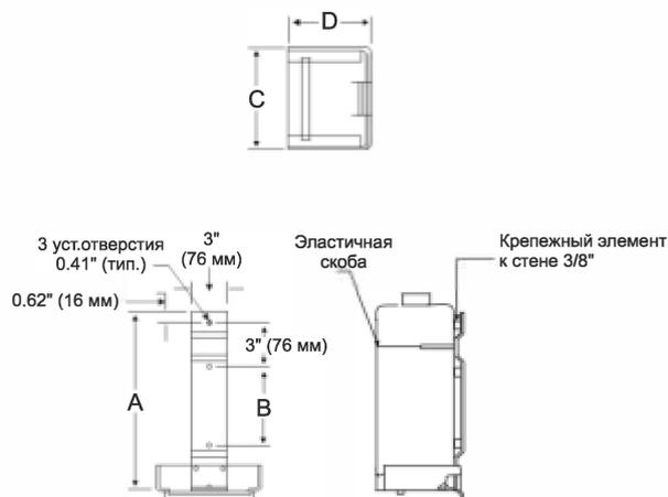
Рис. 24. Настенные кронштейны баллона
