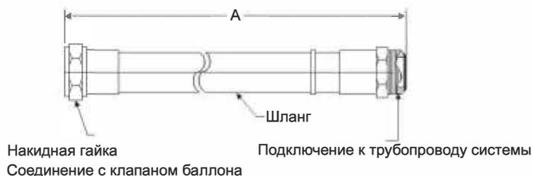
Рис. 11. Рукав высокого давления (РВД) - Тип 1
